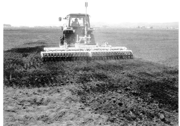
写真2. レーザーレベラーでの均平作業
